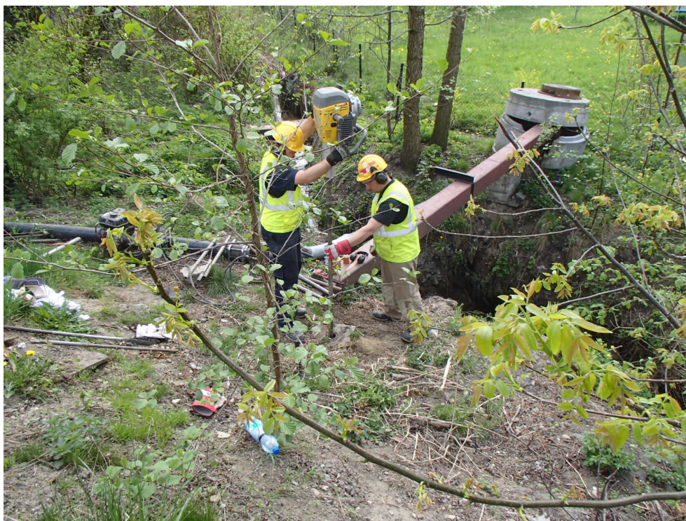
Fot. 22. Punkt nr 3N. Niszowa część osuwiska. Otwór badawczy wykonywany metodą uderową.
