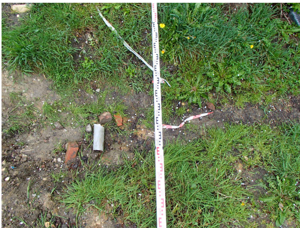
Fot. 16. Rozwarcie we wschodniej części osuwiska – nad drenem kanalizacji (szerokość ok. 70 cm).
