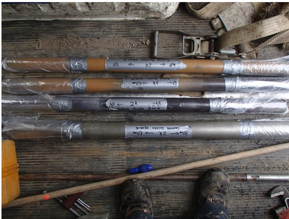
Fot. 23. Zabezpieczone próby rdzeniowe z otworu 2R.
