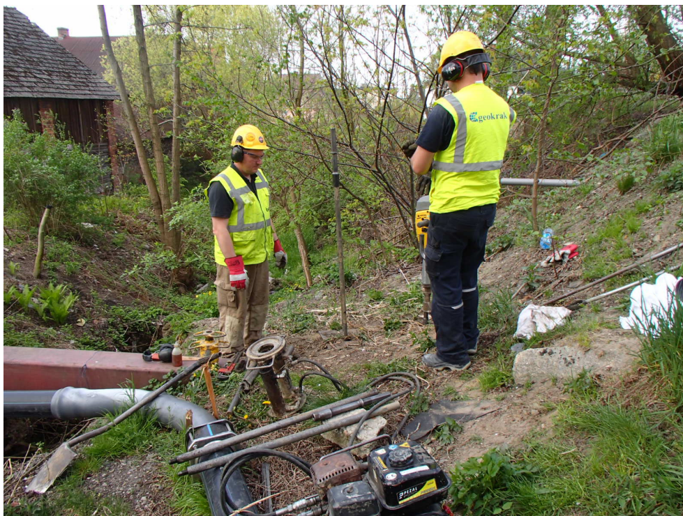
Fot. 21. Punkt nr 3N. Niszowa część osuwiska. Otwór badawczy wykonywany metodą uderową.
