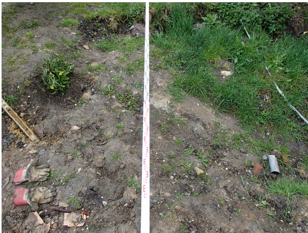
Fot. 15. Skarpa główna osuwiska wraz ze spękaniami w gruncie
