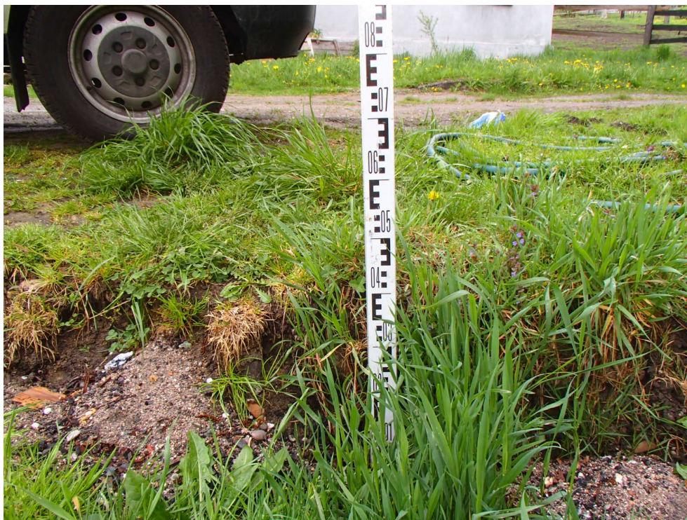
Fot. 17. Skarpa główna w strefie odkucia – wschodnia część (wysokość około 45 cm).
