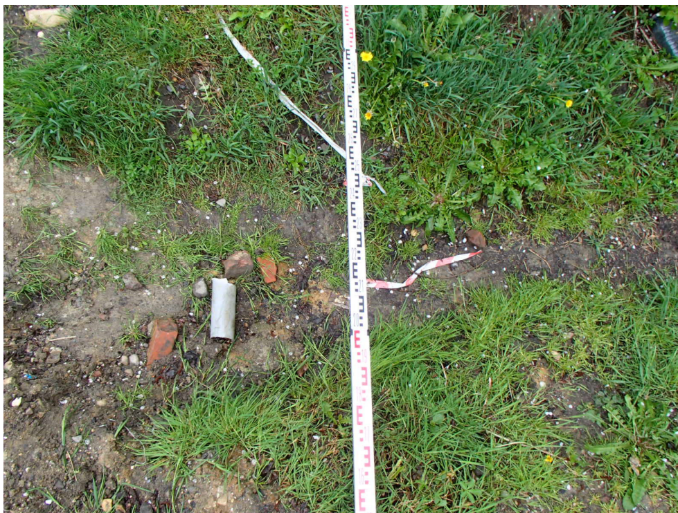
Fot. 16. Rozwarcie we wschodniej części osuwiska – nad drenem kanalizacji (szerokość ok. 70 cm).
