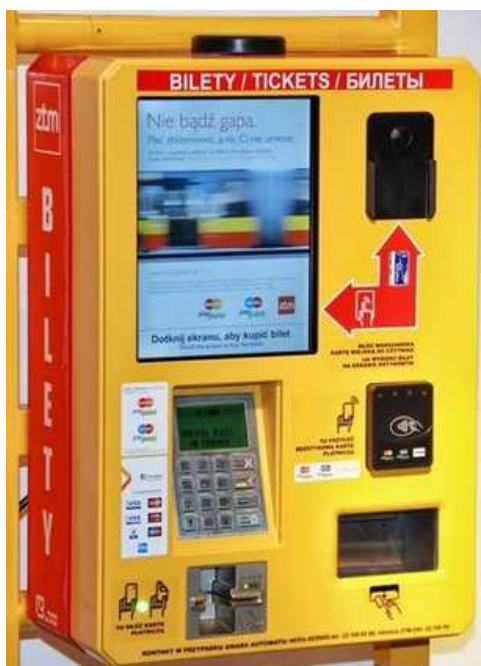
Biletomat „mobilny” montowany w pojazdach komunikacji miejskiej
